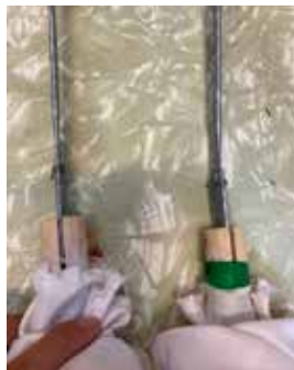
Gambar 10 : Dua kepingan keluli dilipat dua dan diikat diujung antara satu sama lain dengan menggunakan dawai
